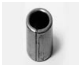
Отклонения размеров и небольшая долговечность вследствие недостаточной концентричности
