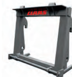
2. Система крепления приставных агрегатов для приставок кормоуборочных комбайнов. Система крепления приставных агрегатов подходит для любых приставок КУК CLAAS JAGUAR типов 497, 496, 494, 493 и 492, 491
